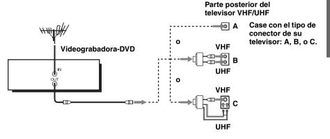
Utilice esta conexión si emplea una antena sólo para VHF (obtendrá sólo los canales 2–13)
